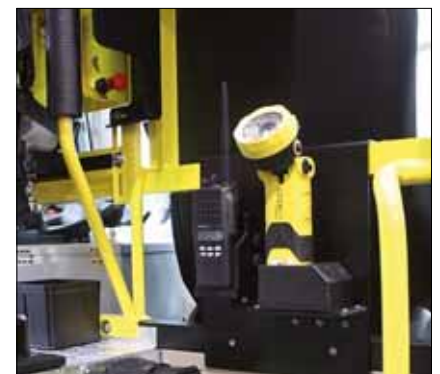
Art.-Nr. B69-7013-B, Ladegerät und Leuchte im Fahrzeug verbaut.
